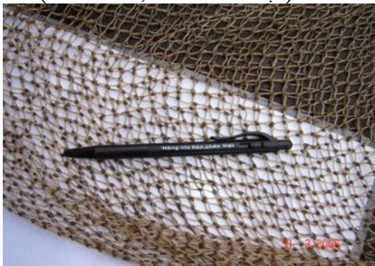
Hình 1. Sử dụng mắt lưới nhỏ cho đục lưới giã cào (16 mm).
